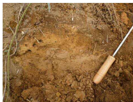
「溝口凝灰角礫岩」(凝灰岩の風化土・半固結状軟岩)
