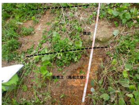
「溝口凝灰角礫岩」(凝灰岩の風化土・半固結状軟岩)
