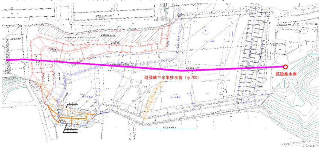
図16 既設地下水集排水管の平面図
