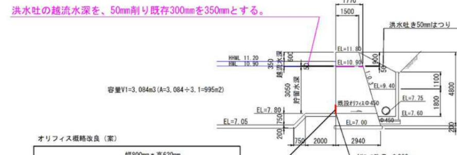
洪水吐の越流水深を、50mm削り既存300mmを350mmとする。
