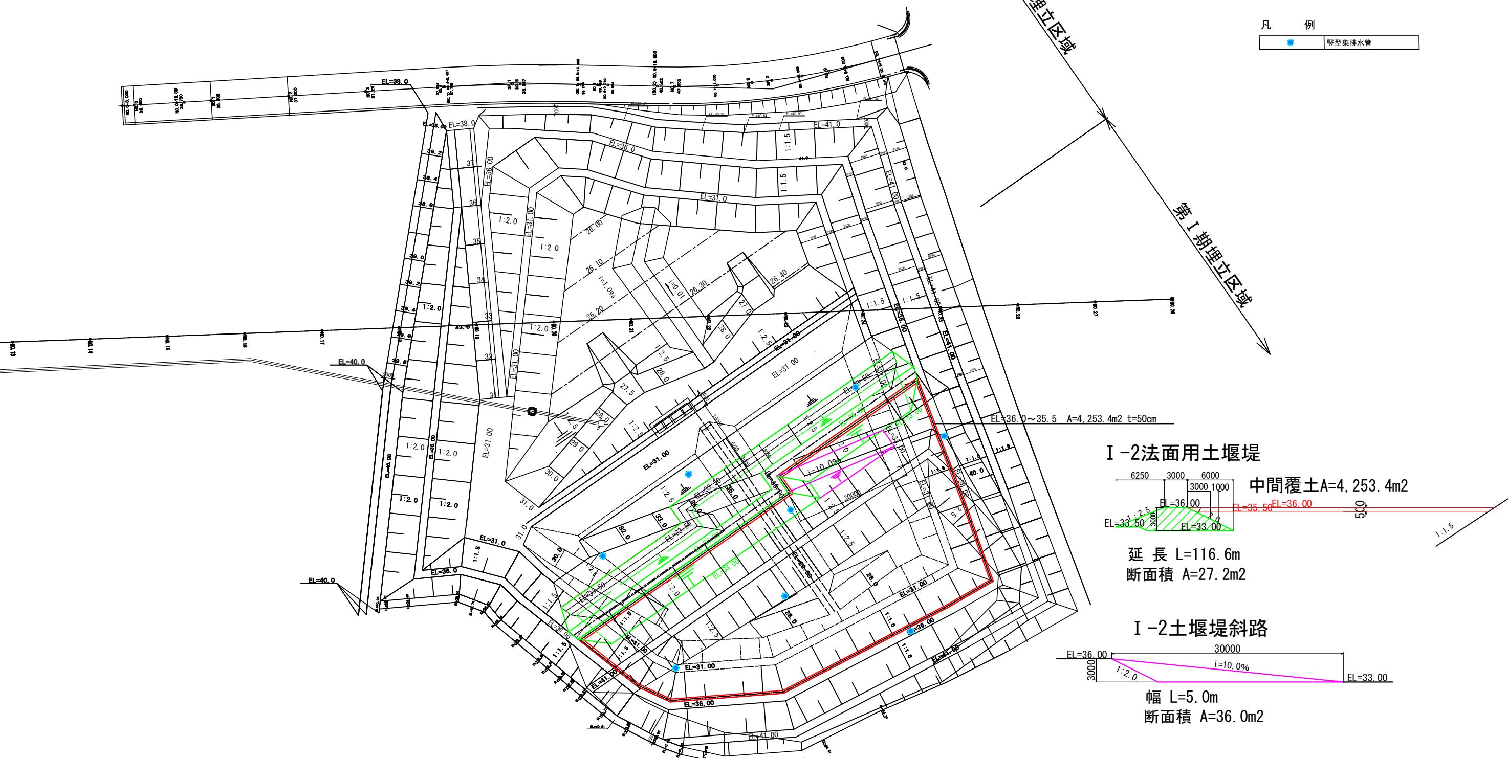
第Ⅰ期(Ⅰ-3)法面用土堰堤土量算出平面図
