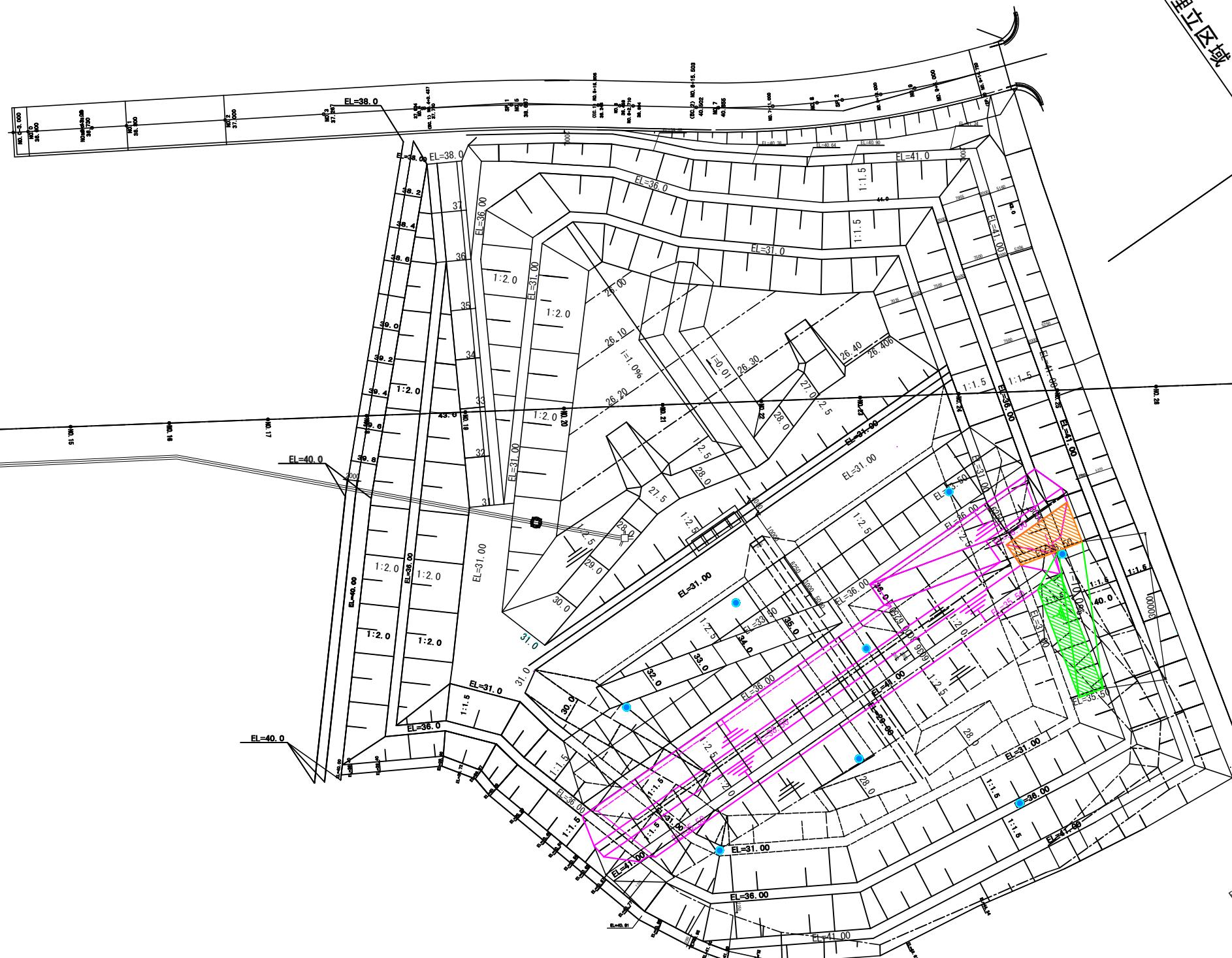
第Ⅰ期(Ⅰ-4)法面用土堰堤土量算出平面図
