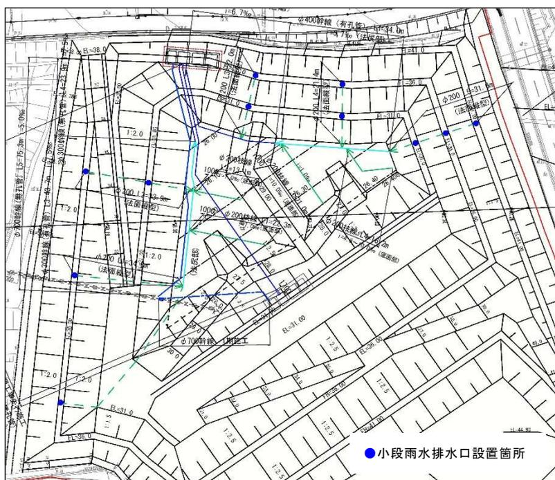
図02-8 小段雨水排水口設置箇所（第Ⅱ期）
